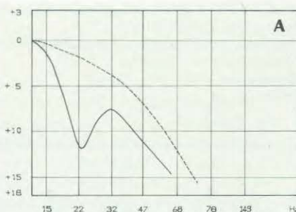
Confronto tra spostamento della membrana (a) e risposta in frequenza (b) di HP 1000 (—) e una cassa a sospensione pneumatica di equal volume (---) realizzata con lo stesso woofer (con la stessa efficienza). Si può osservare che tra 30 e 40 Hz a parità di spostamento (e quindi di distorsione), HP 1000 fornisce una potenza di 4 volte (6 dB) superiore a quella di una cassa a sospensione pneumatica.
